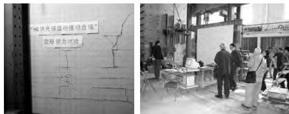
保温填充砌块组合墙平面内 1 / 50 变形能力试验
