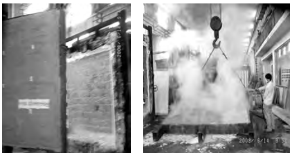
HG 保温砌块在天津公安消防所耐火极限试验
