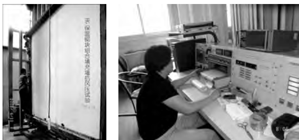
保温砌模抗风压试验
