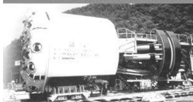
敞开式TBM设备适用于地质自立性好、但硬度较大 地层的掘进作业。
